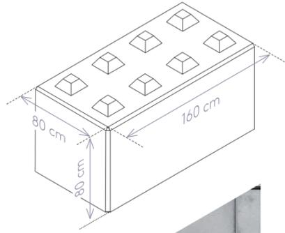
Inspiré du célèbre jeu de construction pour enfant, SOLiBLOC permet d'empiler et de relier facilement des blocs de construction en béton pour fabriquer n'importe quelle structure.
