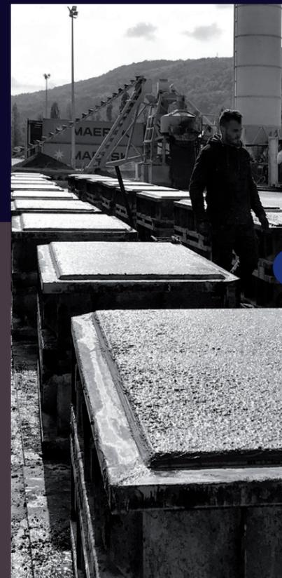
Les SOLiBLOCS sont fabriqués à la demande, sur la plateforme Eiser de Loire-sur-Rhône (69). Ils sont coulés dans des moules en acier, fabriqués eux-mêmes avec exigence.
